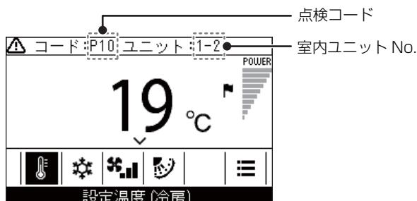
空調機に不具合が発生した場合、リモコン表示部に点検コードと室内ユニット No. が点滅表示されます。
