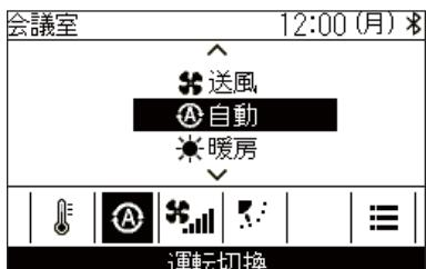
1 「<」「>」を押して「運転切換」画面に切り換える
