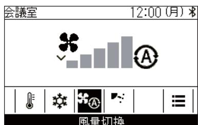
1 「<」「>」を押して「風量切換」画面に切り換える
