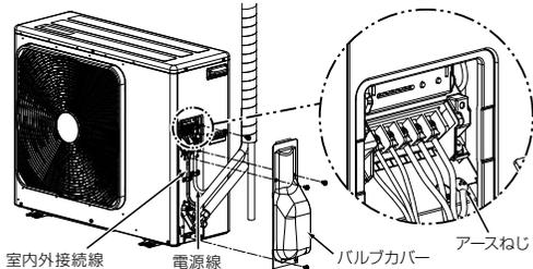
※電源線と室内外接続線は下表の皮ムキ長さを守り、必ず二重被覆部分をコードクランプでしっかり固定してください。火災や発火の原因になることがあります。
